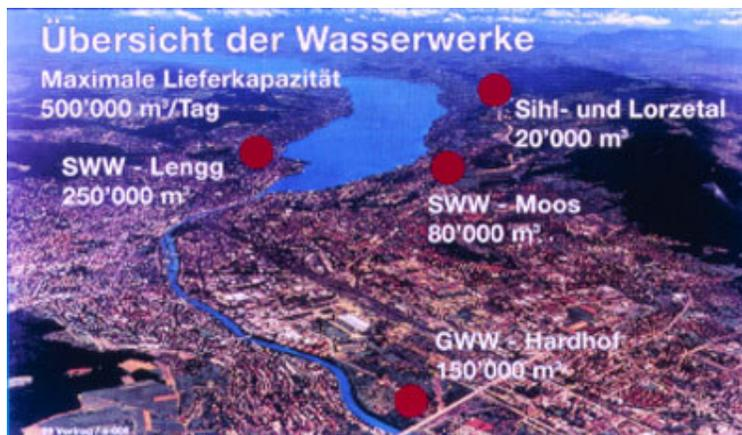
Das Werk Lengg auf der rechten Seeseite ist mit einer maximalen Tagesleistung von 250'000 m<sup>3</sup> Trinkwasser das grössere und modernere Seewasserwerk. Die Anlage aus den 1950er Jahren wurde in die Tiefe gebaut, weshalb sie trotz der grossflächigen Langsandsfilter nur wenig Platz beansprucht. Auf den Dächern wird Tennis gespielt.
