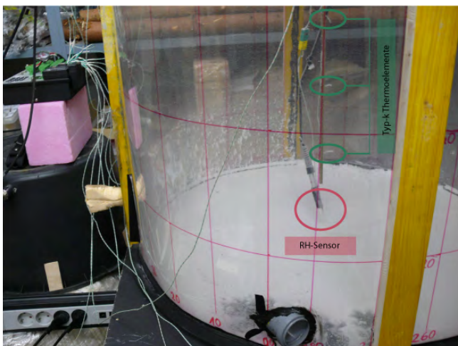
Abbildung 11: Anordnung der Thermoelemente und des Sensors für die relative Luftfeuchtigkeit im kühlbaren Behälter. Kältelabor.
