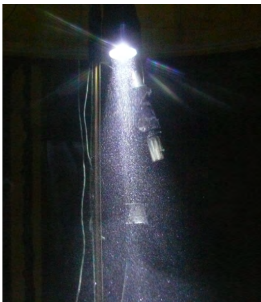
Abbildung 9: Beobachtung der Eiskristall-bildung mit Hilfe eines gebündelten Lichtstrahls.
