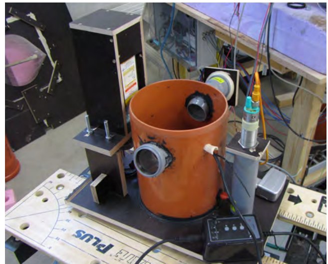
Abbildung 16: Zerstäuberbehälter der letzten Generation, wie er für die weiteren Arbeiten im AP2 verwendet wurde. Ein Nachfüllsystem, links neben dem orangenen Zerstäubervolumen, ermöglichte die Einstellung eines konstanten Wasserspiegels. Minimale Änderungen des Wasserspiegels während des Nachfüllvorgangs wurden mit Hilfe von Ultraschallsensoren (rechts) erfasst. Die Messung der Wassertemperatur erfolgte über den Behälterdeckel (nicht sichtbar). Der Ultraschallzerstäuber wurde in der Mitte des orangenen Zerstäubervolumens positioniert.
