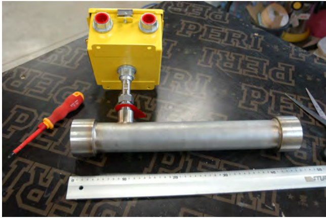
Abbildung 13: Außenansicht Massendurchflussmesser, die Durchflussrichtung ist von rechts nach links mit einem d_i = 68\text{mm} .
