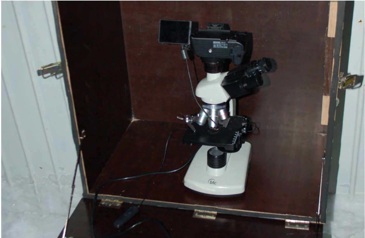
Abbildung 17: Durchlicht-Mikroskop mit 4x, 10x, 40x und 100x Vergrößerung inkl. Trinokularkopf (Modell: BTC-BIM105T). Für die Fotoaufnahmen der Kristalle wurde eine Nikon D5100 mit elektronischem Fernauslöser verwendet. Die Objektträger wurden für die Aufnahmen immer in der selben Position unter dem Mikroskop platziert und mit Hilfe des Kreuztisches an vordefinierte Aufnahmepunkte gefahren, um willkürliche Fotoaufnahmen zu vermeiden.
