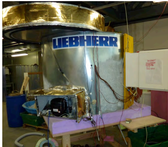
Abbildung 2: Kühlbarer Behälter, gebaut während des Projekts PRIZE. Volumen 1.0\text{m}^3 .
