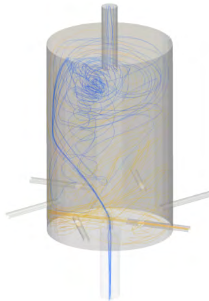
Abbildung 25: Strömungssimulation des kühlbaren Behälters – Strömungslinien [m/s]
