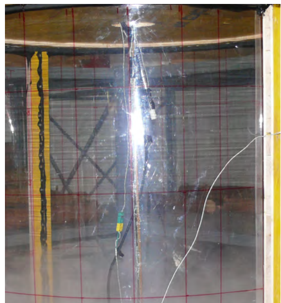
Abbildung 10: sichtbare Wolke im unteren Bereich des Behälters, unsichtbare Eiskristalle bei normaler Beleuchtung.
