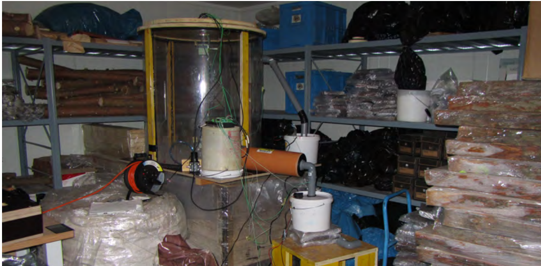
Abbildung 19: Beispiel für das Variantenstudium mit Einlässen inkl. Nebelzufuhr bei den Öffnungen B und E sowie dem Auslass an der Position D. Ziel der Tests mit diesem Set-up war die räumliche Trennung zweier Nebelluftströme, um den Eiskristallen in der aufwärtsgerichteten Strömungsspirale zusätzliche Feuchtigkeit für das Wachstum zur Verfügung zu stellen.
